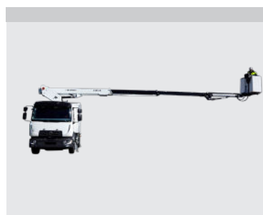
Udsving på drejetårn og støtteben inde for køretøjets sidespejle
